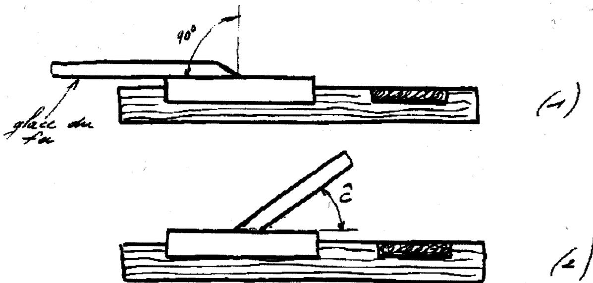
Pour raboter les baguettes il faudra appuyer fermement sur le rabot, c'est la semelle du rabot qui pousse à fond la baguette dans le V. La main droite tient le rabot et la main gauche équipée d'un gant de jardinier tient la baguette. Un aimant pas trop puissant tient la baguette sur la partie la plus fine et s'éjecte lors de la poussée du rabot.
