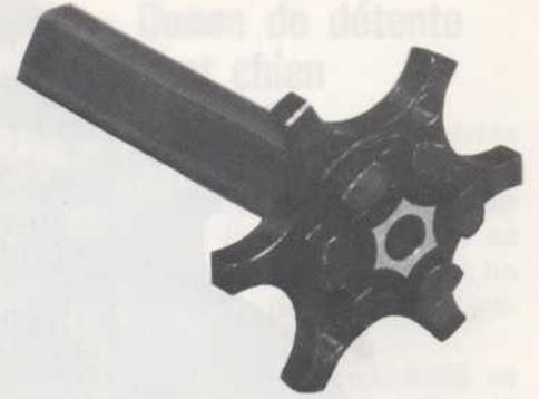
L'étoile qui assure l'entraînement en rotation du barillet et l'extraction des étuis. Très bel usinage.
