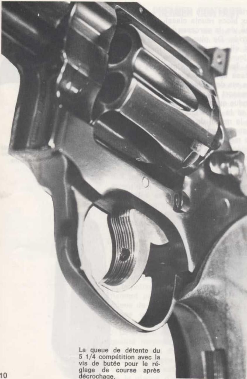
La queue de détente du 5 1/4 compétition avec la vis de butée pour le réglage de course après décrochage.
