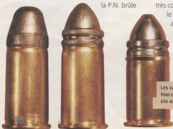
Les cartouches Delvigne sur étui de 22 mm correspondent au chambrage réel du 73. Elles demandent la confection d'un outillage spécial et ne sont accessibles qu'à un advanced reloader bien équipé. Le sertissage latéral a été exagéré pour la clarté de la photo. A droite, la cartouche Lynx sur étui 18 mm que l'on sertira si on le peut
