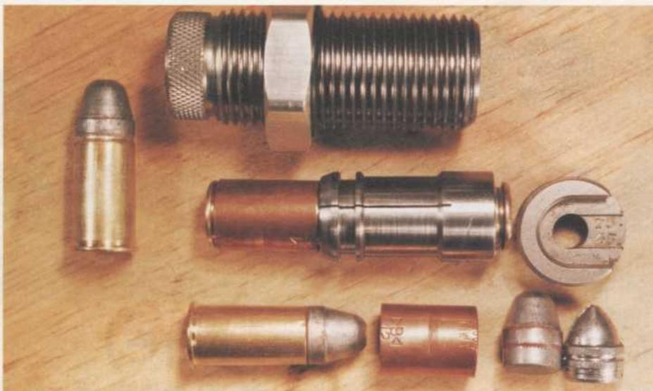
Une cartouche est en position de sertissage dans la griffe dans son guide de profondeur qui règle le placement du cran de sertissage. La griffe est solidarisée au shell holder par un culot de 44-40 tronqué collé à l'araldite. La griffe monte avec la cartouche et son guide de profondeur dans la matrice creuse et le degré de sertissage est réglé par la position de la bague six pans fileté de la matrice.
