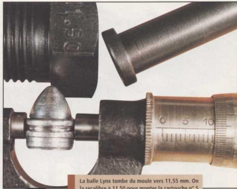
La balle Lynx tombe du moule vers 11,55 mm. On la recalibre à 11,50 pour monter la cartouche n° 5 de notre en-tête. Elle sera lubrifiée à l'Alox. La base bevel et l'incrémentation de quelques centièmes des diamètres arrière facilitent les opérations.
