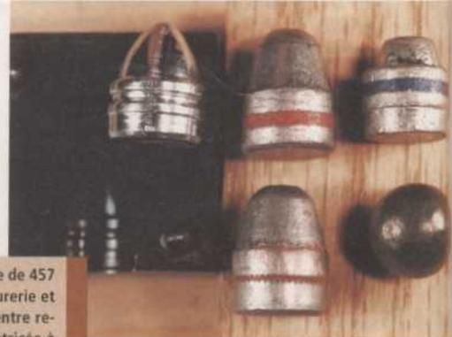
Les balles du 73 sont également spécifiques. La balle ronde de 457 et la petite SWC 160 grains au dessus se trouvent en armurerie et permettent des montages avec un outillage réduit. Au centre recalibrage à 429 de la ceinture basse d'une balle de 45 matricée à froid. A gauche, l'excellente balle Lynx 916805 avec son moule.
