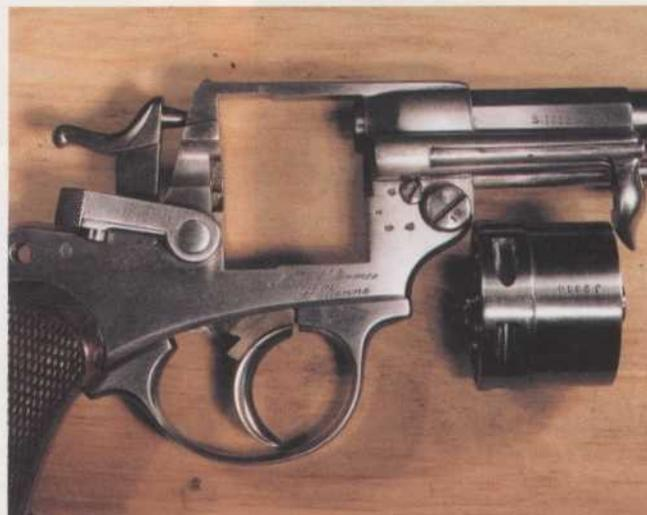
Dépose du barillet et des garnitures.
