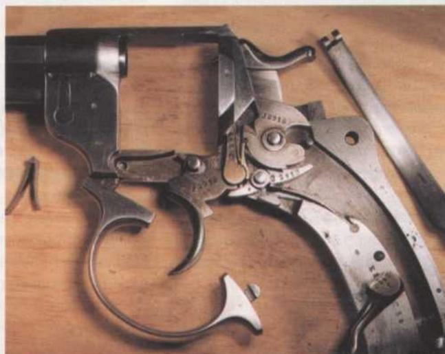
Dépose de la plaque de recouvrement du pontet et du grand ressort.
