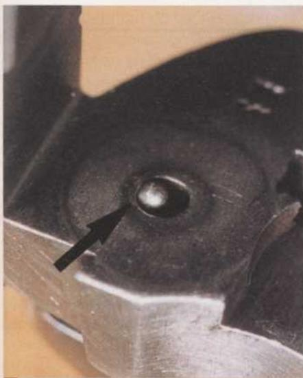
La percussion est source de problèmes. Lorsque le percuteur apparaît il n'est pas centré. Il ne se centre que s'il va en bout de course avec 3,5 mm d'émergence. Avec les amorces Large Pistol la pénétration du percuteur est réduite et l'excentrage de l'impact vers le haut est excessif. Le trou n'est pas obturé et l'amorce gonfle en bas parce que non soutenue. Si la pression monte un tantinet, la rotation du barillet en sera perturbée. Il y a bien sûr une solution.
